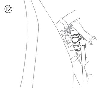
⑫ 將原廠固定螺絲鎖上並插上矽膠管，安裝即可完成
