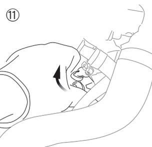
⑪ 將組裝完成的SENSOR與轉接座裝回原廠位置，並將SENSOR依照箭頭方向轉入檔點
