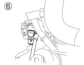
⑥ 拆下原廠SENSOR固定螺絲
