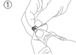
① 先用止漏膠帶纏繞鋁合金接管鎖牙處
