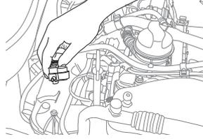
7. 放上轉接座和感應器用手指稍作壓力住下壓，讓轉接座微卡在進氣歧管上
