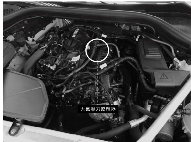
步驟2：將拆下的原廠接頭裝在轉接座上
