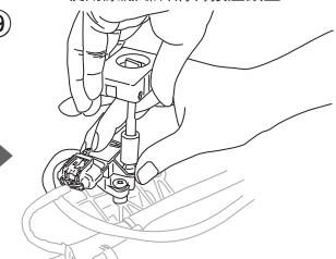
使用附贈加長螺絲，將原廠壓力感應器鎖上，固定轉接座上
