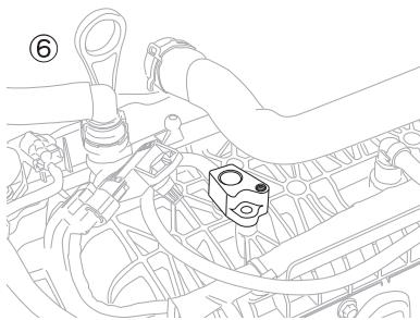
將轉接座安裝至原本壓力感應器所安裝的位置上
