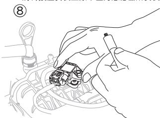
將拆的原廠壓力感應器，安裝至轉接座上
