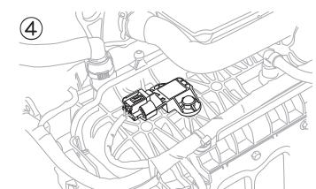
打開引擎蓋護板，找到壓力感應器
