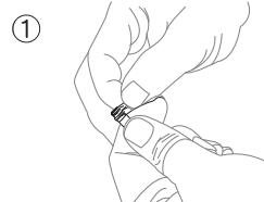
先用止漏膠帶繞鋁合金接管鎖牙處
