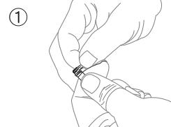
先用止漏膠帶纏繞鋁合金接管鎖牙處
