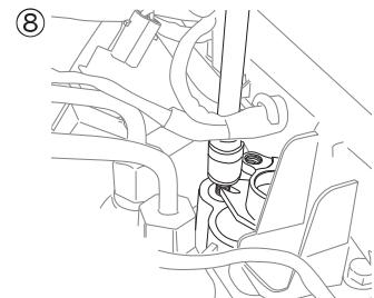
取出本體轉接座開口邊置入預鎖螺絲處銷緊
